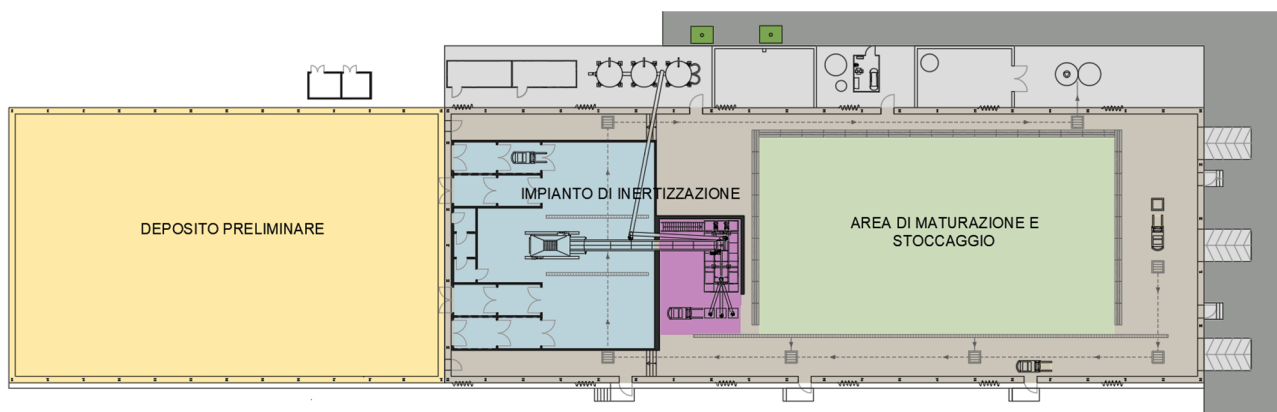
Figura 3.5 - Planimetrie "Deposito Preliminare" e "Capannone Impianto" con ubicazione dell'impianto di Inertizzazione e dell'Area di Maturazione e Stoccaggio
